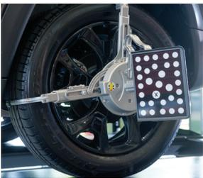
Die Radklammer greift mit begrenzter Spannkraft auf dem Reifen, ohne die Felge zu berühren. So wird jedes Mal ein sicheres, schnelles und gleichmäßiges Klemmergebnis gewährleistet.
